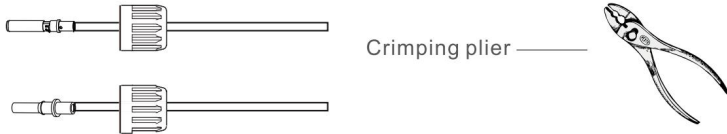
Imaginea 3.4 Sertizează pinul de contact pe fir
