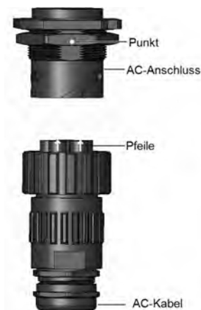
Abbildung 16: Verbindung des AC-Anschlusses mit einer Sekundäreinheit
