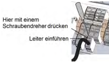
Abbildung 23: DC-Federklemmen
